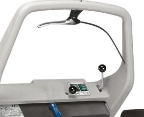
Betriebssteuerungen: Steuerung zum Schließen/ Öffnen der Ansaugvorrichtung, Rüttelfilter, Anheben/Absenken der Seitenbürste, Steuerung des Maschinenvorschubs (bei den Modellen mit Antrieb).
