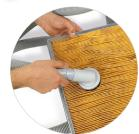
Es ist wichtig, bei jedem Maschineneinsatz den Plattenfilter mit einem Staubsauger zu reinigen, um einen optimalen Betrieb der Maschine zu garantieren.
