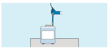
Das Produkt mit geeigneten Sauglanzen an das Dosiergerät anschließen.
